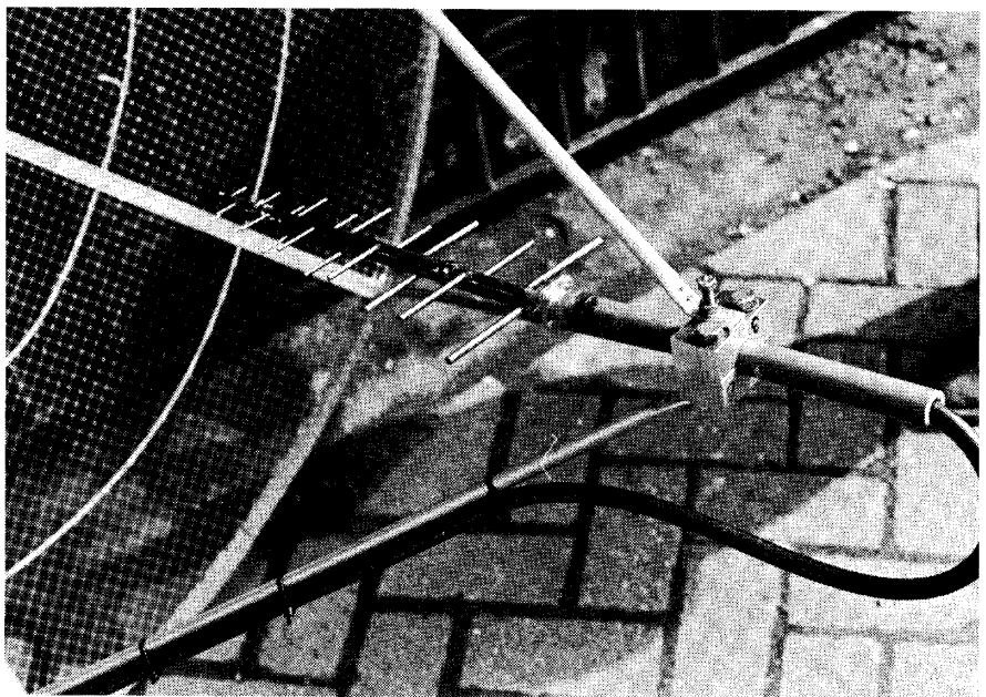
Foto 3. Montage van de L.P.D.-straler met aluminium blok en PVC buis. Zie ook fig. 3.
